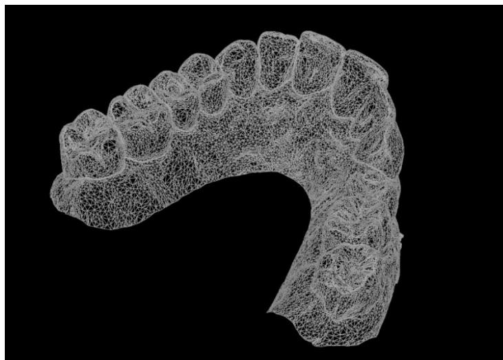
Figura 3-Malha triangular digital constituída por minúsculos pontos (STL)
