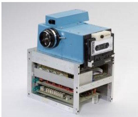
Figura 2: Primeiro protótipo de uma câmara fotográfica digital, criado por Steve Sasson para a empresa Kodak, em 1975
