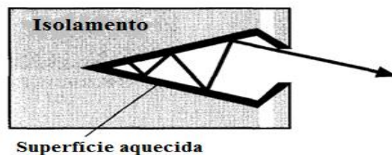
Figura 17 – Representação da variação da emissividade com a geometria [33].
