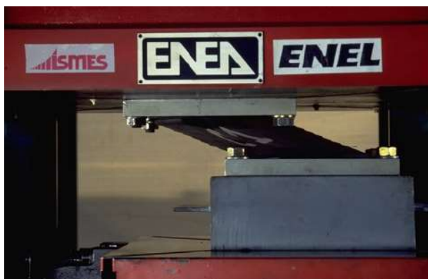
Figura 12 - Apoio HDRB submetido a forças de corte. Adaptado de [12].
