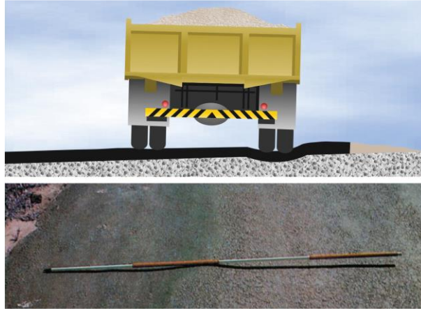
Figura 4.6 Deformação permanente num pavimento (DER/SP, 2012)
