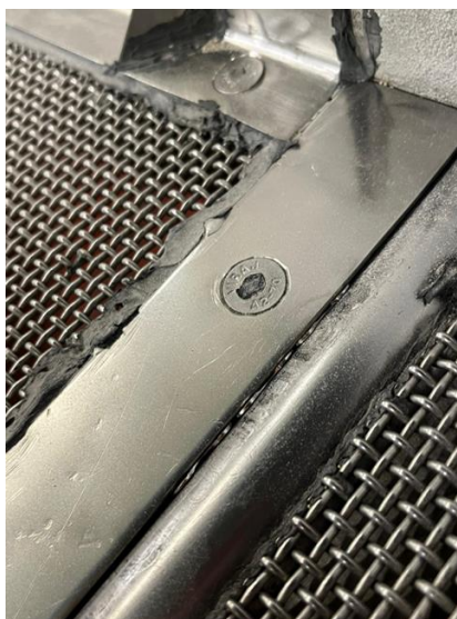
Figura 10.22 – Folga na rede de evacuação da secadora com placas retidas.
