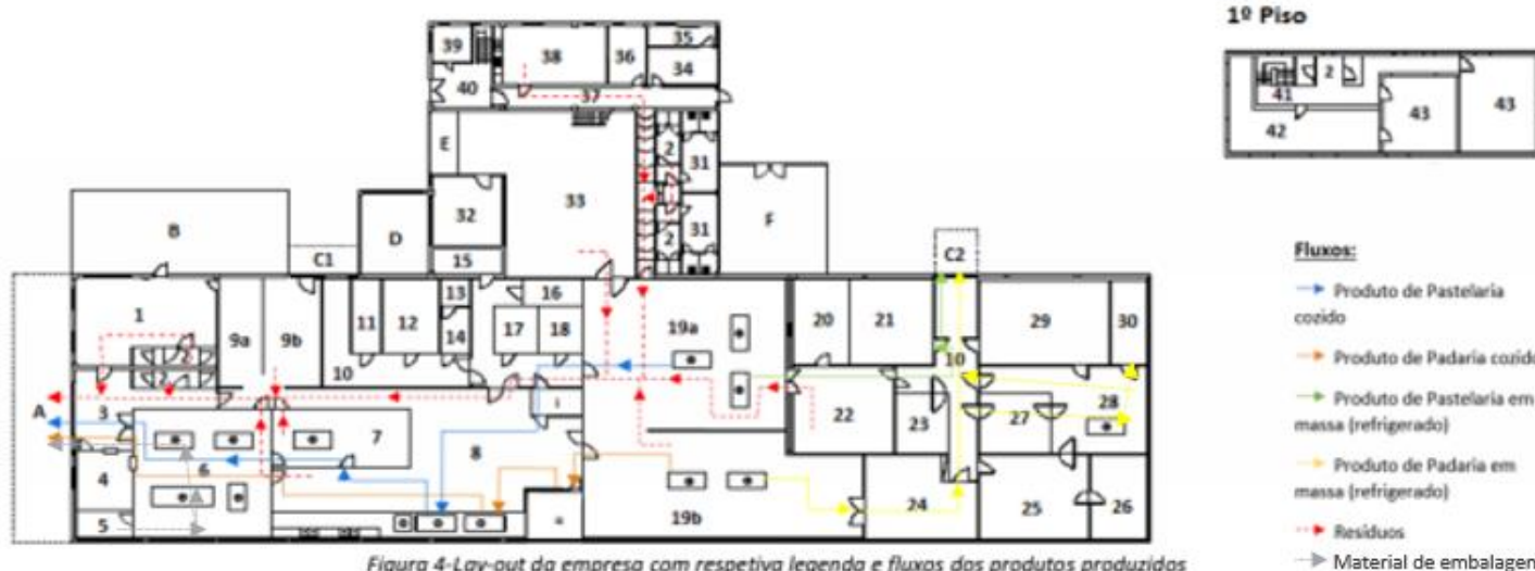
Figura 4-Lay-out da empresa com respetiva legenda e fluxos dos produtos produzidos
