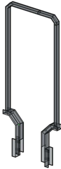
Figura 3.14 – Modelo para análise de elementos finitos correspondente ao ensaio físico.
