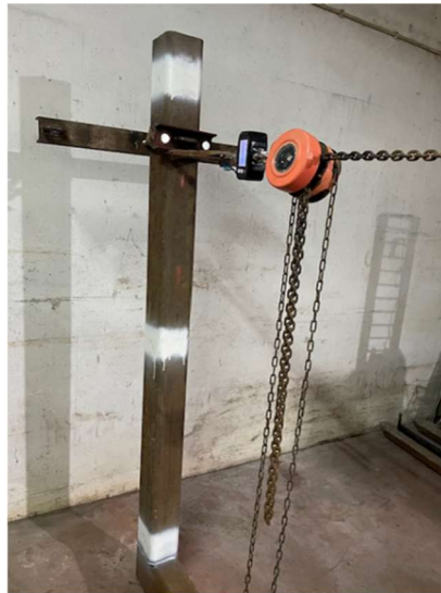
Figura 3.36 – Montagem do esticador e da balança na bancada de ensaio para o ensaio horizontal.
