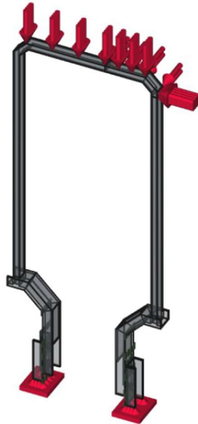
Figura 3.16 - Modelo ensaio com restrições de graus de liberdade e conjunto das forças aplicadas.
