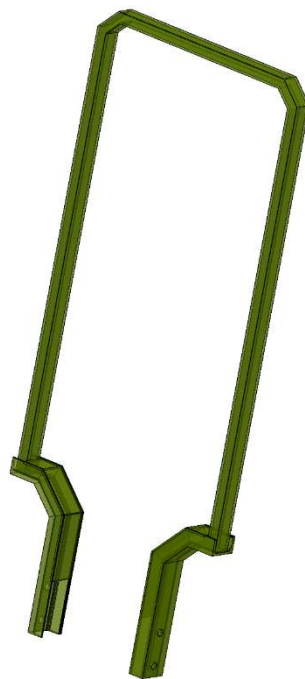
Figura 3.7 – Esboço conceptual da estrutura de proteção (1695mm x 728mm x 80mm).
