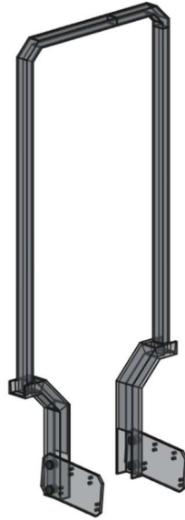
Figura 3.12 – Modelo para análise de elementos finitos correspondente à montagem no trator.
