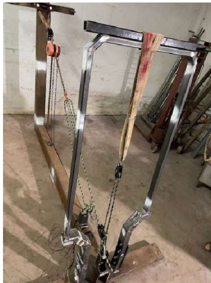
Figura 3.39 – Montagem da estrutura e da cinta de tração no ensaio de esmagamento.
