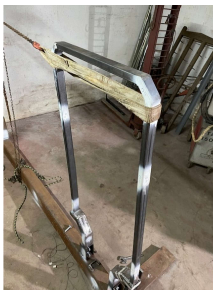
Figura 3.37 – Montagem da estrutura e colocação da cinta de tração no ensaio de carga lateral.
