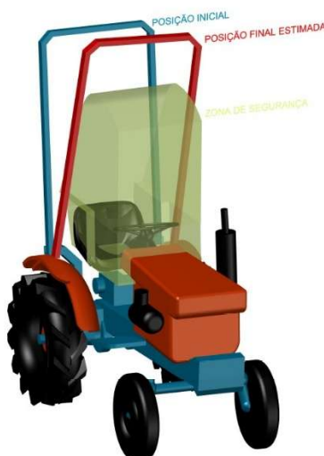
Figura 3.52 – Simulação dos deslocamentos aplicados ao modelo 3D.
