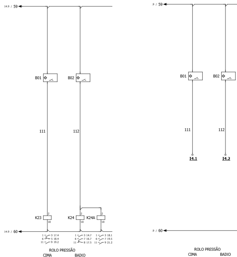
Figura 37 - Ligação das fotocélulas às entradas do PLC
