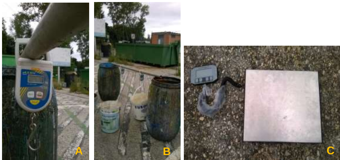
Figura 20 - Balanças usadas na pesagem dos resíduos urbanos. A – Balança digital de capacidade máxima 50 kg, B – Balança digital de capacidade máxima 50 kg e de 15 kg, respectivamente e C – Balança digital de capacidade máxima 75 kg.
