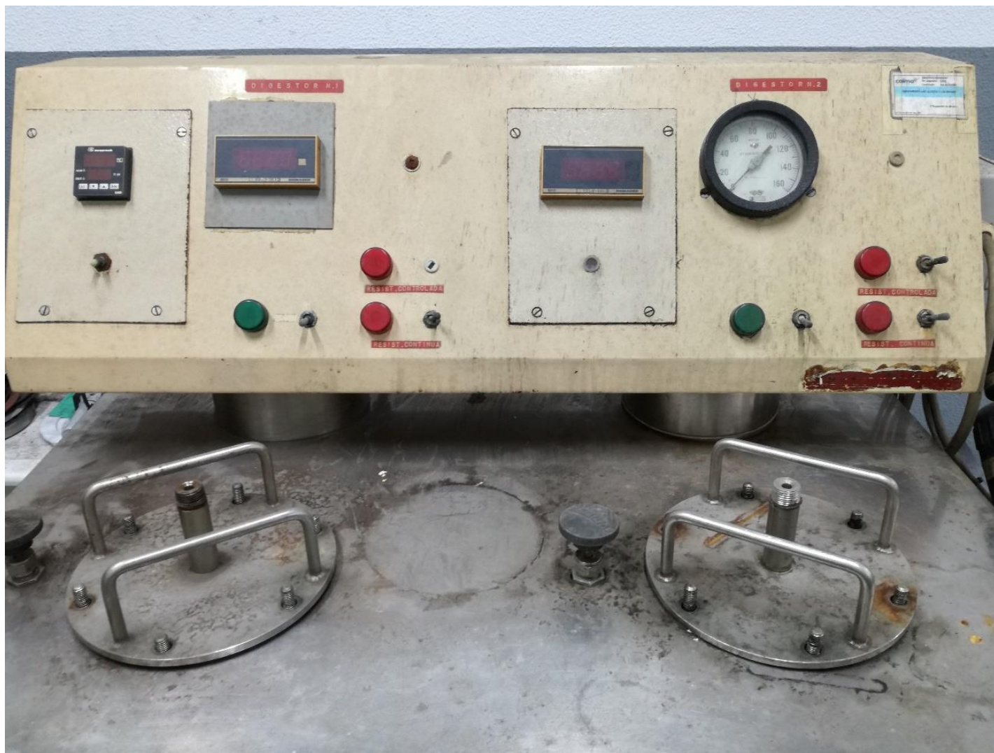
Figura 49 - Digestor Piloto Frente
