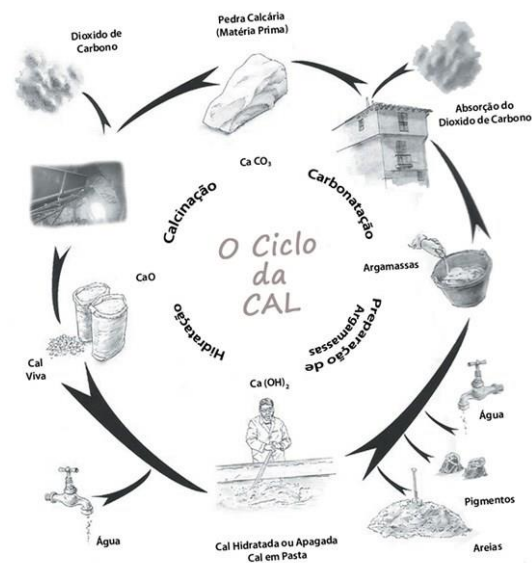
Figura 22- Esquema do ciclo da cal. Fonte: < http://www.maxical.pt/?id_sub=ciclo >;
