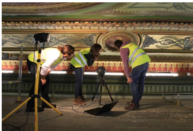
Figura 38- Fotografia durante a análise multiespectral a um dos retratos do teto do salão nobre. Fonte: Marco Mota;
