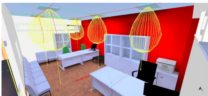
Figura 6.21 – Curvas de distribuição de luz inseridas no modelo da secretaria.
