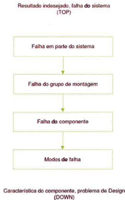
Figura 1.12 – Procedimento básico para a estruturação de uma árvore de falhas
