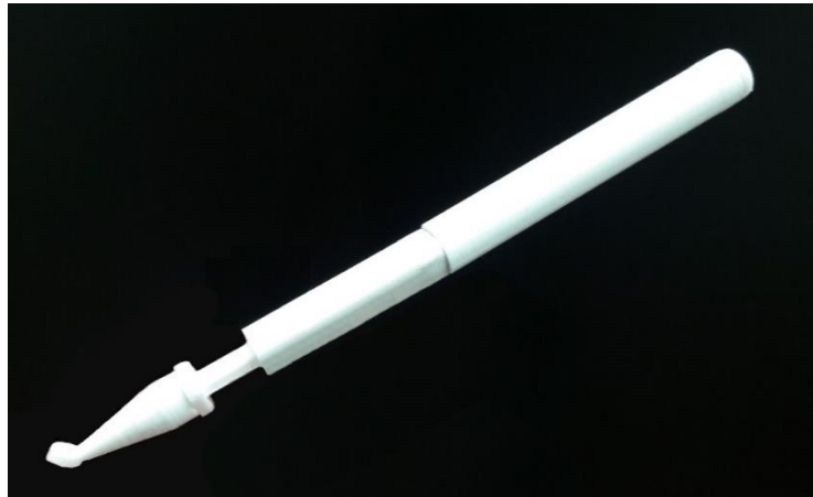
Figura 3.27 - Protótipo produzido em PLA (poliácido láctico).
