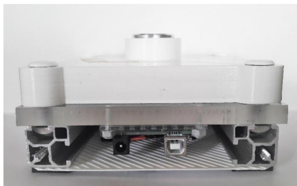
Figura 4.4 - Estrutura com o perfil Minitec ® e com a placa Arduino ® .
