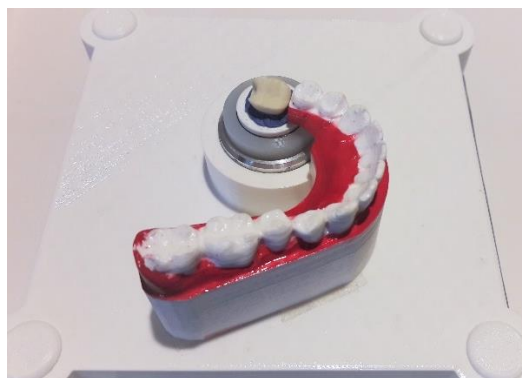
Figura 4.7 - Sistema de medição de força com o modelo anatómico dos dentes.
