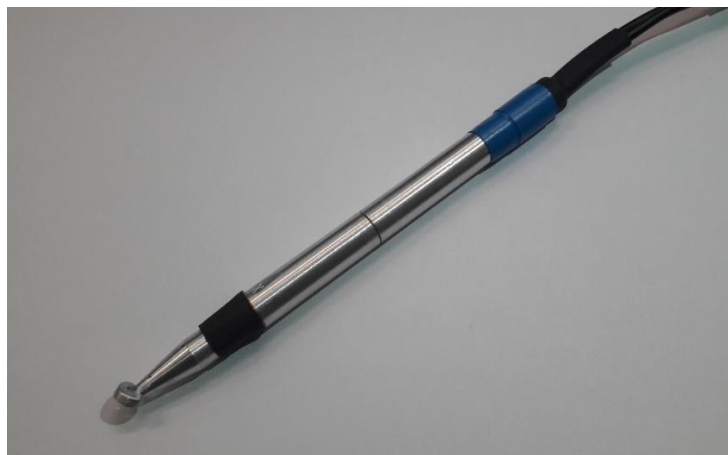
Figura 3.28 - Protótipo funcional produzido por maquinagem convencional.
