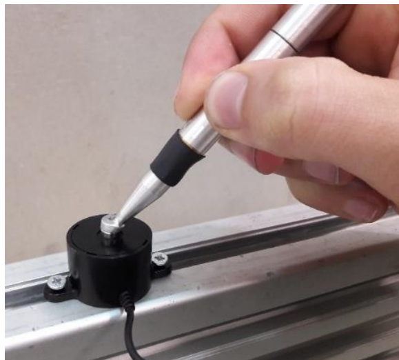
Figura 3.32 - Aplicação de força na célula de carga, usando o dispositivo.
