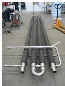
Figura 19 - Permutador de mosto.
