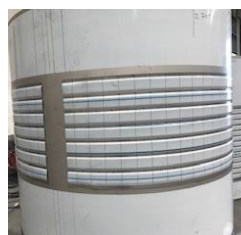
Figura 36 - Camisa soldada por pontos.
