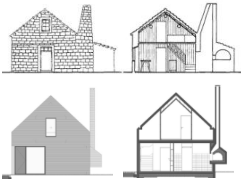
Figura 79 - Interpretação do modelo tradicional (Superior - modelo tradicional, inferior - modelo proposto)
