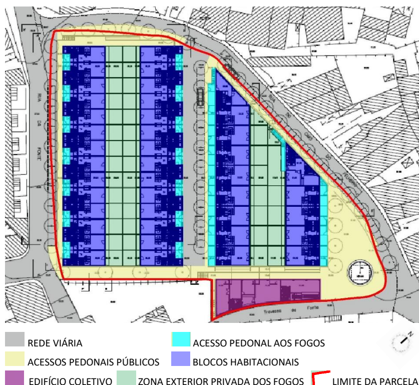
Figura 114 - Planta de Implantação (Telheiro)
