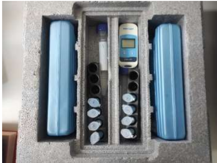
Figura 1 Caixa para Simulação de Transporte de Amostras de Sémén e o Termómetro
