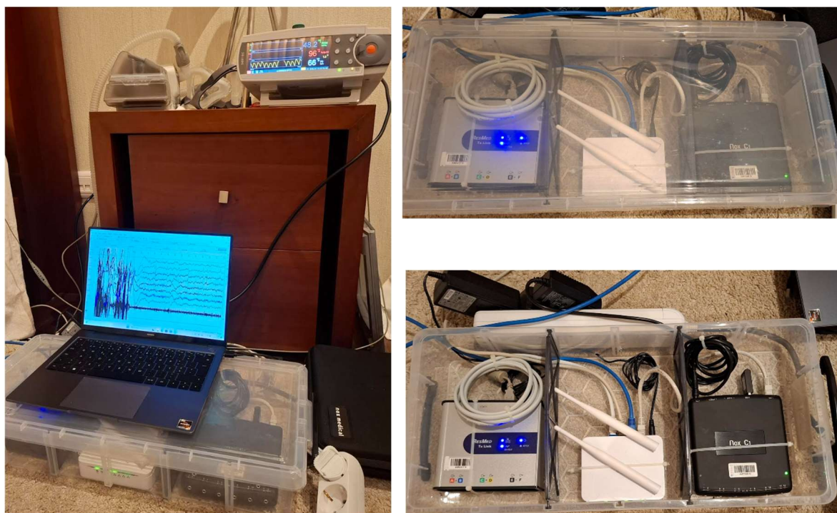
Figura 4 - Posto de aquisição portátil com PC, Nox C1™, Resmed TxLink™, capnógrafo e router
