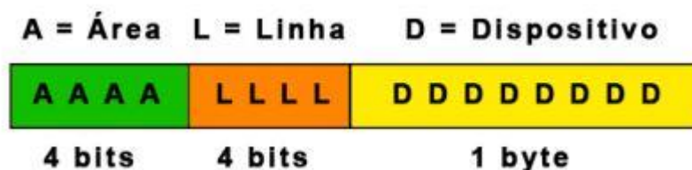
Figura 11 - Estrutura, em numeração binária, de um endereço físico KNX (da Silva, 2016)
