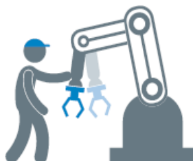
Figura 41 - Limitação da força e da potência [99]
