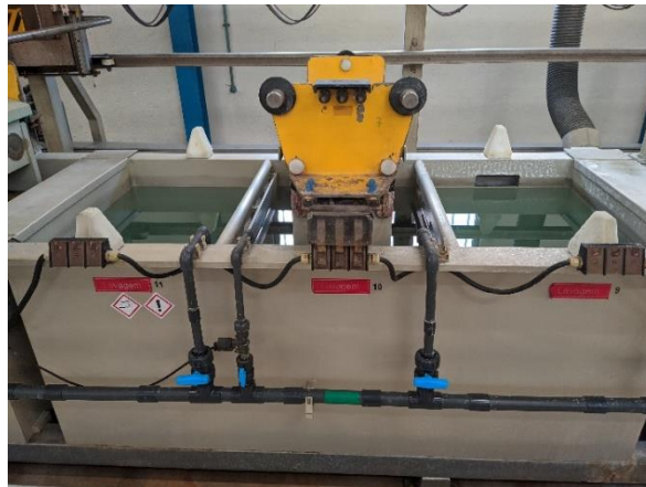
Figura 27: 2 postos em cascata da lavagem dos sais ácidos, (9 e 10); 1 posto de lavagem em água sulfúrica (11).
