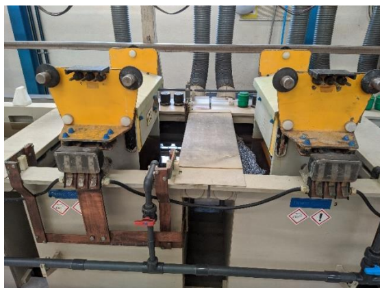
Figura 24: Zonas de desengorduramento de peças.
