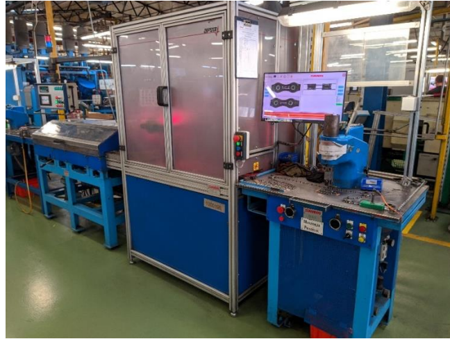
Figura 20: Máquina de detecção de defeito.
