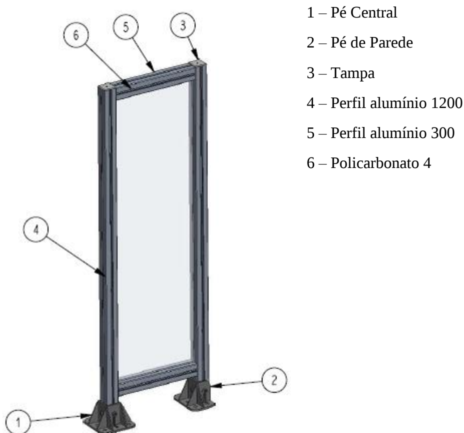
Figura 56: Constituição da Barreira Física Fixa.
