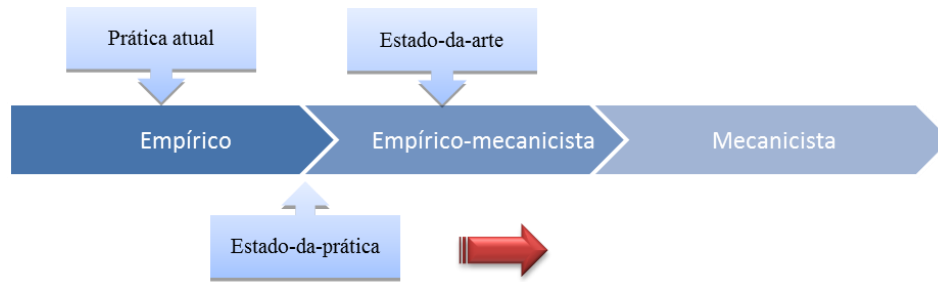
Figura 3.6 - Famílias de métodos de dimensionamento de pavimentos utilizados (adaptado de Brito et al, 2009)
