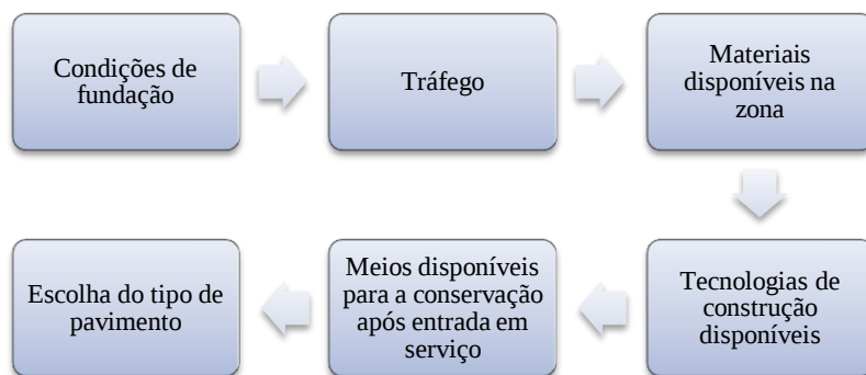
Figura 2.3 - Fluxograma de conceção de pavimentos de EBVT (adaptado de Fortunato et al, 2013)
