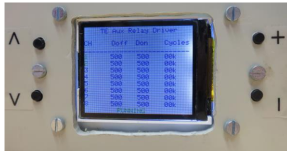
Figura 134: Ecrã com a representação dos tempos dos relés
