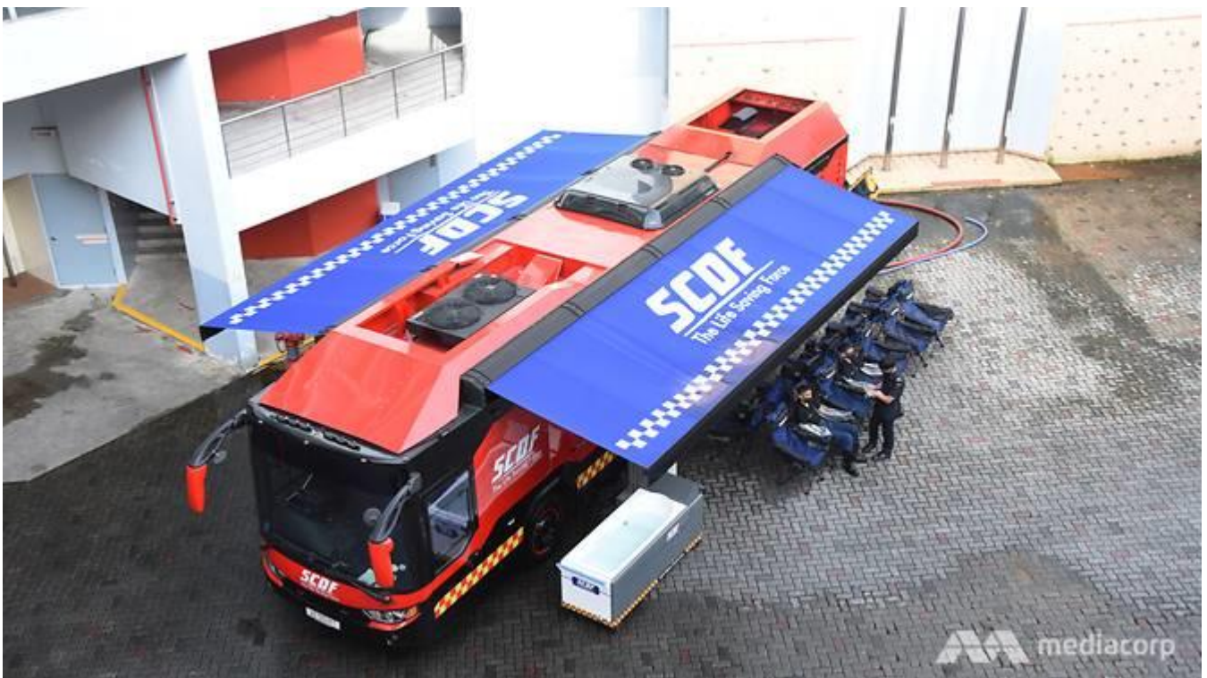
Figura 12: RPV montado para fornecer sombra. Fonte: mediacorp
