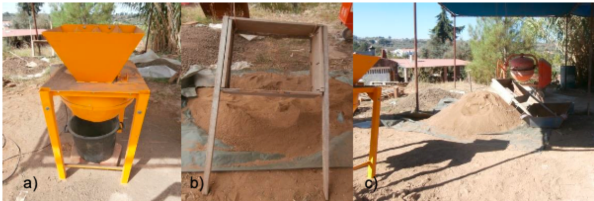
Figura 14 - Equipamentos e material utilizado na produção: a) Pulverizador mecânico de pás; b) Peneiro com 4mm de abertura; c) Terra após pulverização e peneiração (Silva, 2015)
