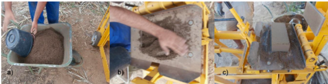
Figura 16 - A) Dosagem da mistura; B) Colocação da mistura na prensa; C) Moldagem do bloco. (Silva, 2015)
