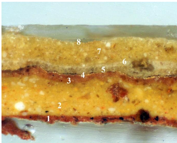
Fig. 33 - Microfotografia estratigráfica (100x) da amostra MARD-2: 1- suporte; 2- camada de preparação branca original; 3- bolo-armênio; 4- folha de ouro; 5- primeira camada de preparação branca do "redouramento"; 6- segunda camada de preparação branca do "redouramento"; 7- terceira camada de preparação branca do "redouramento"; 8- purpurinas.
