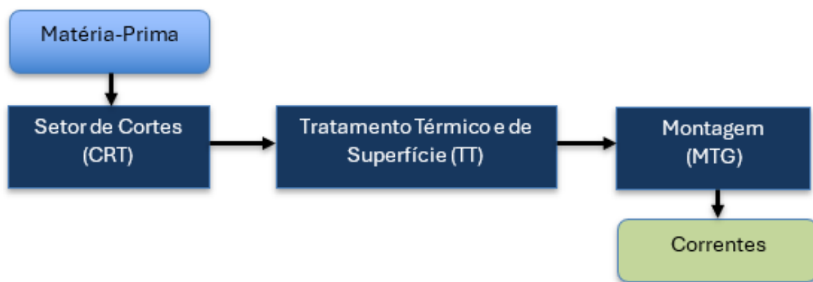
Figura 15 – Representação do fluxo produtivo da SRAMPORT. (Imagem do autor)
