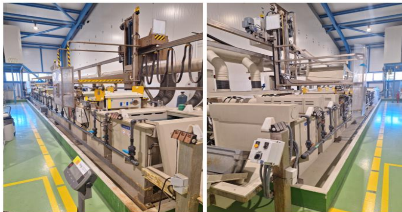
Figura 24 – Representação da Linha Niquelagem 1 e 2 [27].
