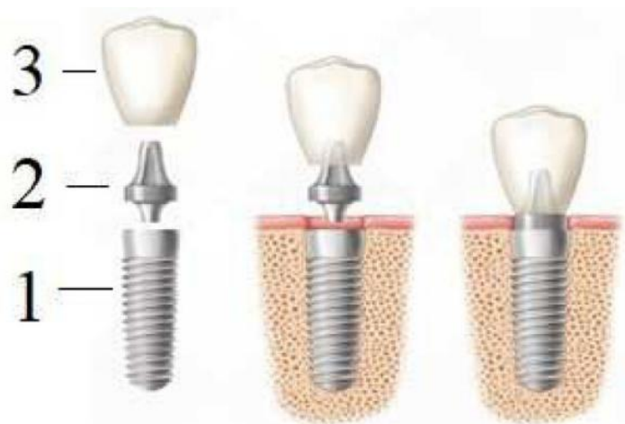
Figura 1: Composição de uma prótese dentária sobre implante
