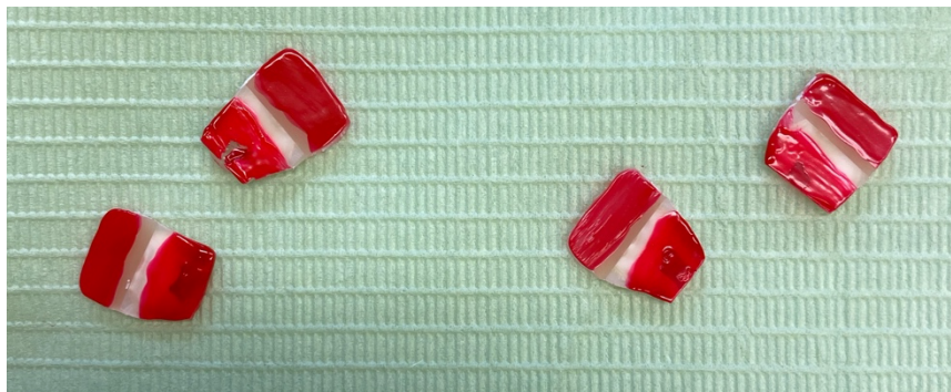
Figura 14 – Preparação das fatias de 0,7mm com revestimento a verniz para observação FEG-SEM
