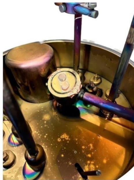
Figura 17. Discos de resina cobertos com ouro e paládio.
