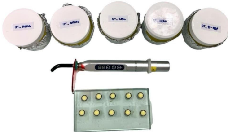
Figura 5. Confeção de discos de resina.
