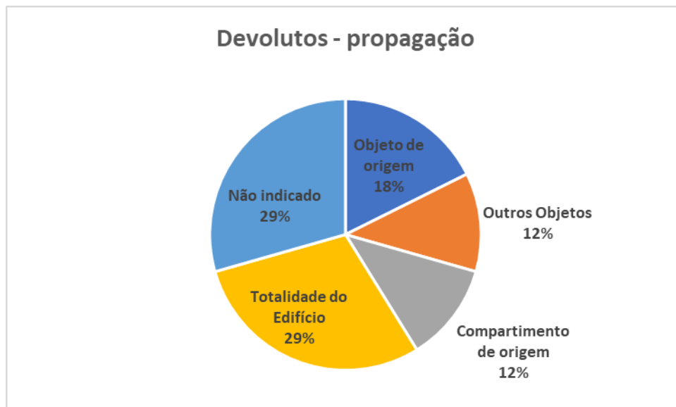
FIGURA 58 - PROPAGAÇÃO DE INCÊNDIOS EM EDIFÍCIOS DEVOLUTOS
