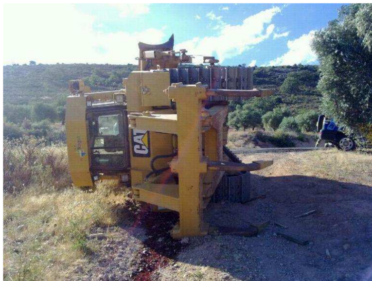
Figura 27 Máquina tombada ao descarregar (Guadalajara 2012)
