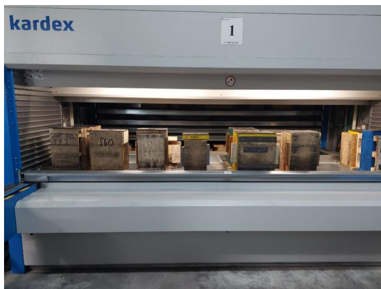
Figura 6 - Pormenor do interior do armazém KARDEX, na troca de uma placa molde.
