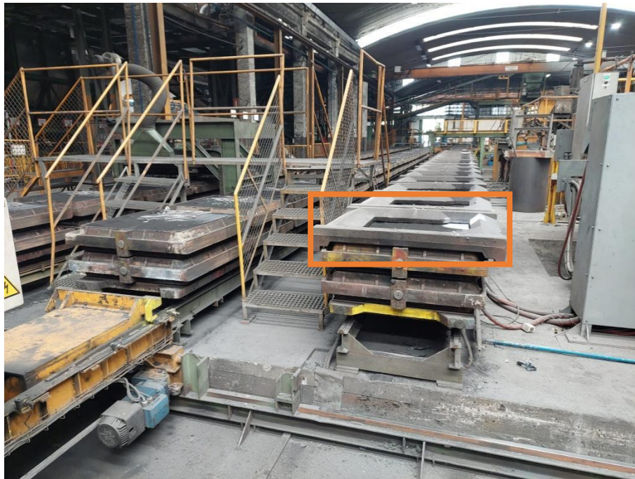
Figura 21 - Moldações seguindo para o vazamento com colocação de pesos metálicos para que não exista desalinhamento nas moldações.
