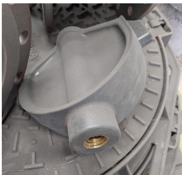
Figura 29 - Peças rebarbadas prontas para receber pintura a preto por imersão.
