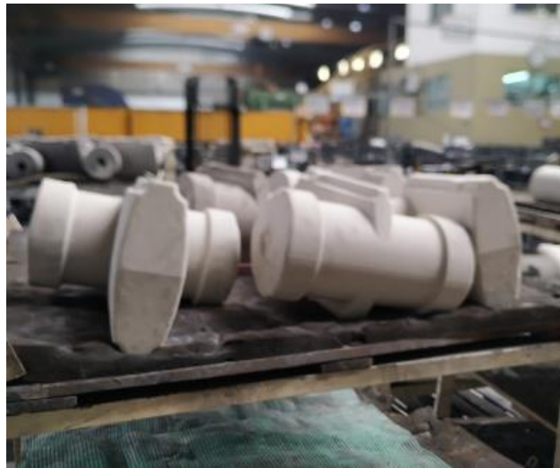
Figura 16 - Machos prontos e colocados em sistemas de alimentação da linha de produção da Fucoli-Somepal, S.A.
