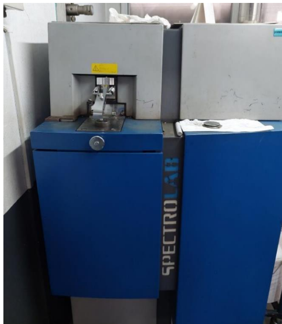
Figura 18 - Visualização do espectrómetro que é usado para análise dos constituintes do banho de ferro.
