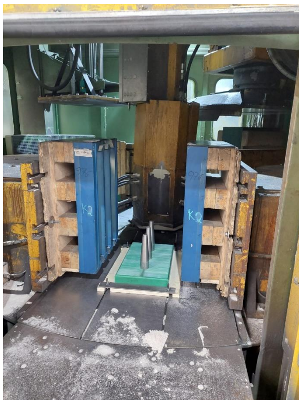
Figura 12 - Exemplo da entrada da caixa de machos com extração automática na máquina BICOR 3300.
