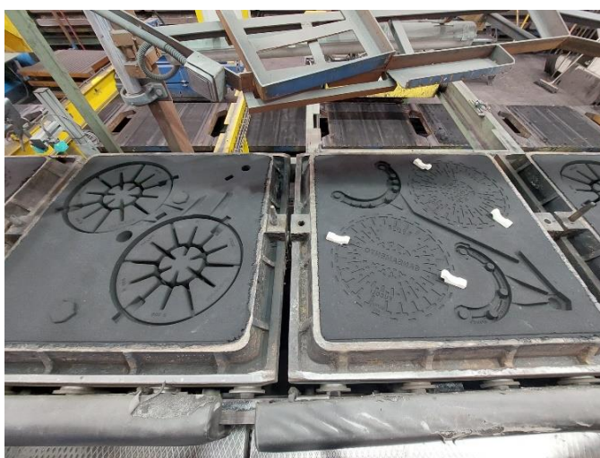
Figura 8 - Exemplo de uma meia moldação superior de a meia moldação inferior.
