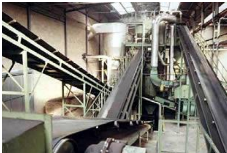
Figura 19 - Visualização do sistema de telas, responsável pela alimentação dos vários constituintes da areia verde para os moinhos.
