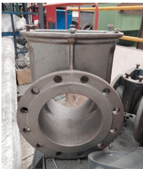
Figura 30 - Visualização de um "T" onde se procedeu à maquinação por CNC das falanges de aperto.
