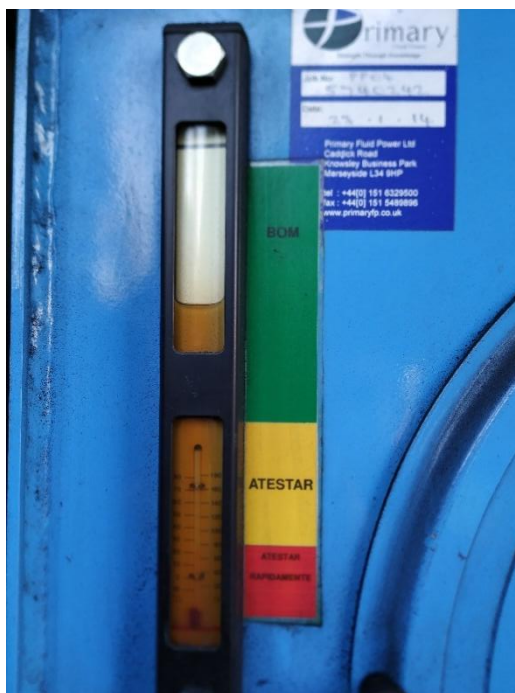
Figura 47 - Implementação de etiquetas com informação visual no nível de óleo das máquinas do sector da macharia.
