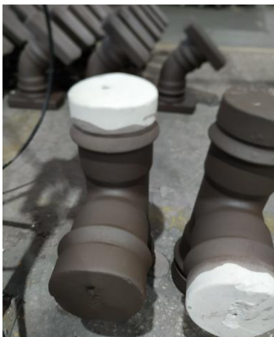
Figura 15 - Exemplo da pintura de machos através da aplicação de tinta de base aquosa.
