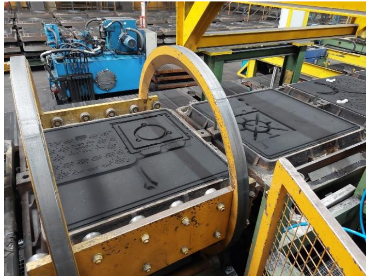
Figura 27 - Visualização dos carrinhos de transporte das caixas, o designado Sistema Dyutec.
