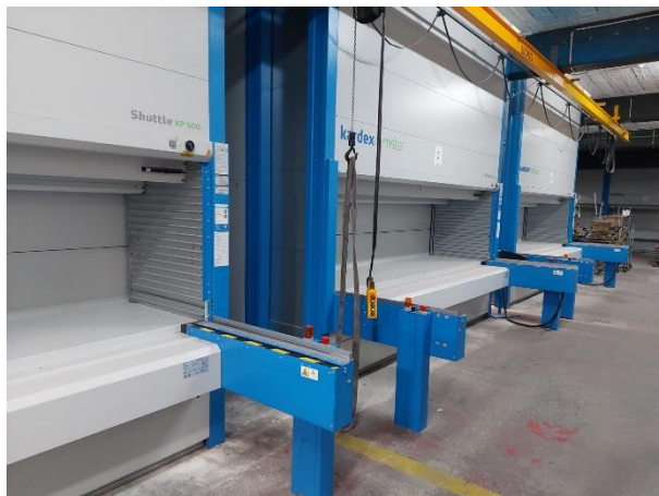
Figura 5 - Imagem do KARDEX no armazenamento das placas molde e das caixas de machos.
