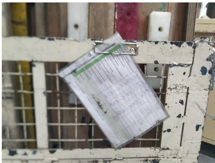
Figura 49 - Sistema de fixação das fichas nas caixas de machos.
