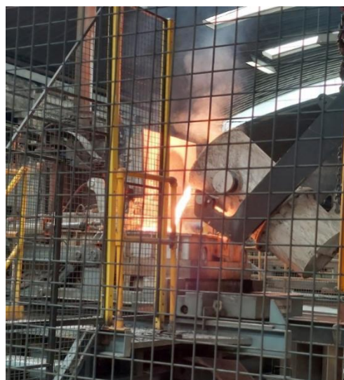
Figura 24 - Visualização do vazamento do metal líquido depois do acerto da sua composição química.
