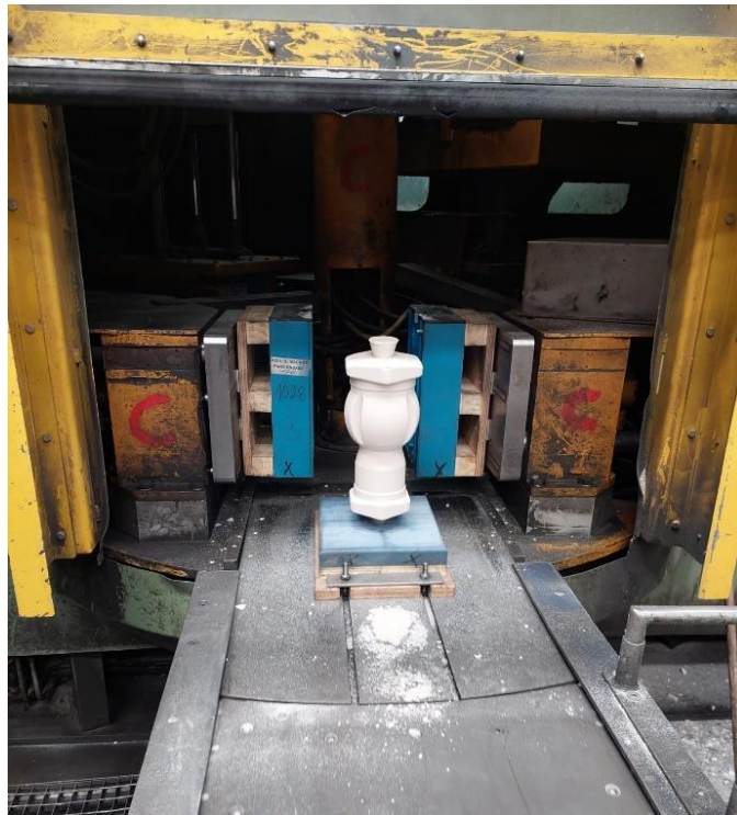
Figura 13 - Resultado final do processo de produção de um macho.
