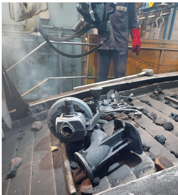
Figura 28 - Visualização das peças à saída da máquina de granalha.
