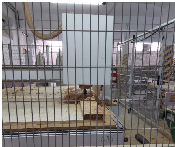
Figura 31 - Visualização da maquinagem de um molde em madeira.
