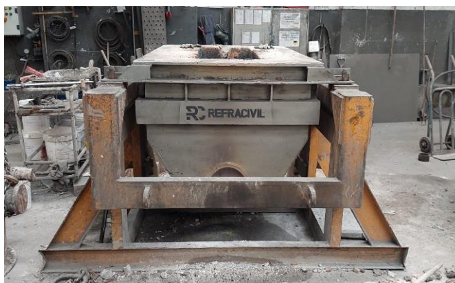
Figura 26 - Visualização do sistema Tundish em processo de reparação.
