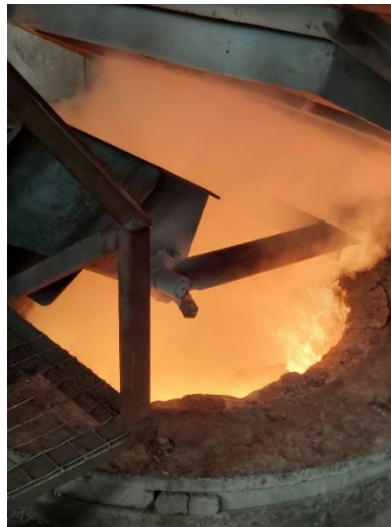
Figura 23 - Imagem da boca do forno de indução da Fucoli-Somepal S.A. onde é possível visualizar o metal no estado líquido.
