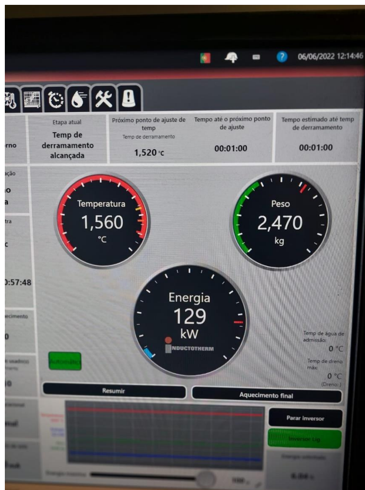
Figura 40 - Visualização do novo sistema operativo de controlo dos fornos, com informação sobre alguns parâmetros da fusão.
