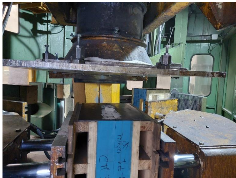
Figura 14 - Visualização da caixa de machos colocada no equipamento para deposição da areia e sua compactação.
