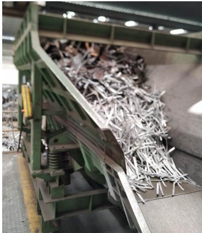
Figura 41 - Vagonete com carregamento de sucata e pronta para ser adicionada ao processo de fusão.
