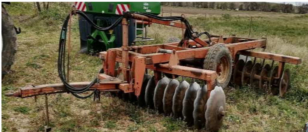
Figura 13- Grade de discos pesada, marca Galucho modelo glhr 28-26
