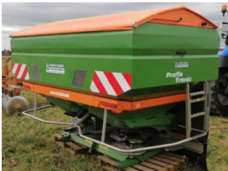
Figura 16- Distribuidor centrífugo, modelo za-v 4200
