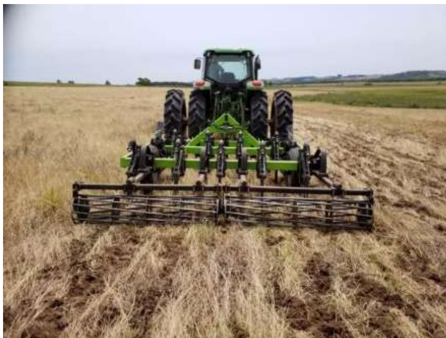
Figura 4- Máquina operadora de mobilização com órgãos ativos na vertical e grade de gaiolas (Compre Rural, 2020)
