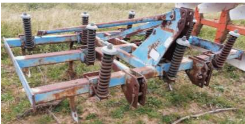
Figura 14- Escarificador pesado “Chisel”, modelo ch 9 3
