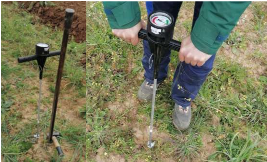
Figura 9 - Penetrómetro de cone, sonda de meia cana e martelo (lado esquerdo), penetrómetro de cone (lado direito)
