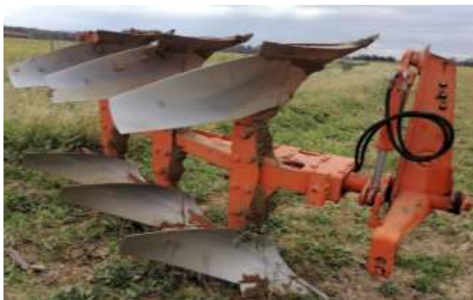
Figura 12- Charrua de aivecas, modelo ch3- 12h
