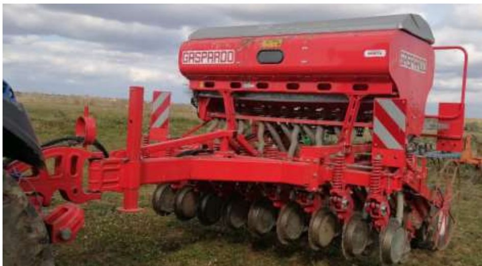
Figura 17- Semeador Gaspardo mecânico em linhas de chassis fixo, de fluxo contínuo, modelo diretta
