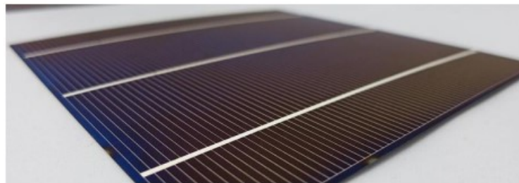
Figura 3.10: Exemplo de uma célula fotovoltaica com três busbar soldados longitudinalmente [31].
