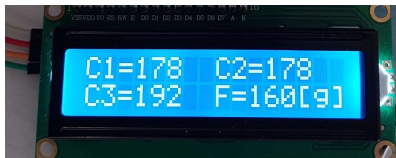
Figura 196 - Valores de carga em cada dedo do sensor e valor mínimo de força. Fonte: (Própria)
