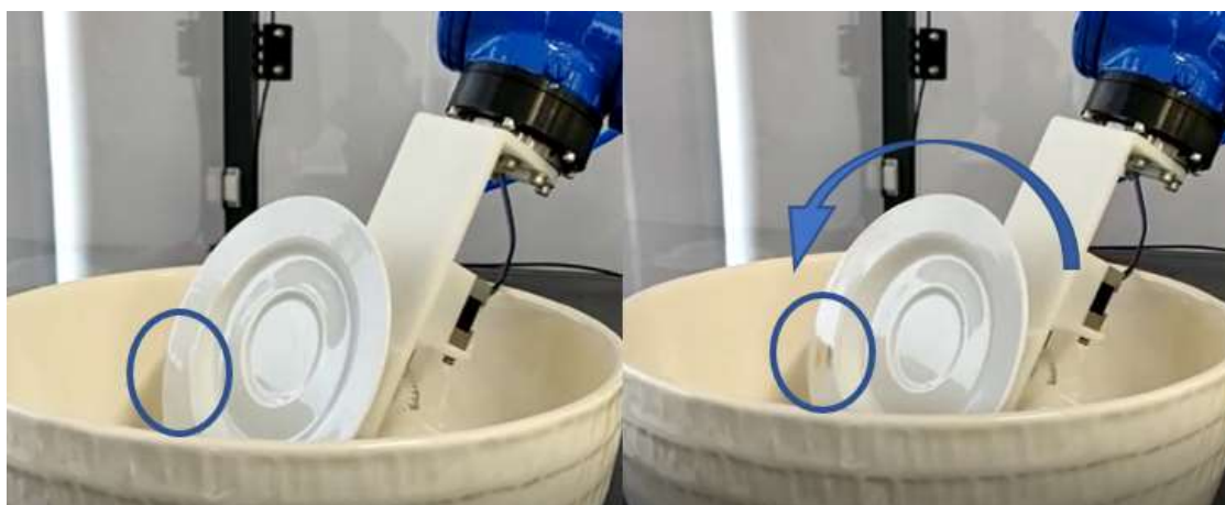
Figura 148 - Simulação de mergulho do pires com rotação. Fonte: (Própria)
