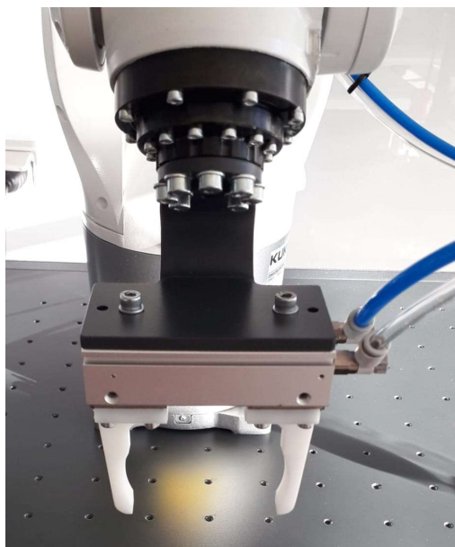
Figura 157 - Garra adaptada montada no robô. Fonte: (Própria)
