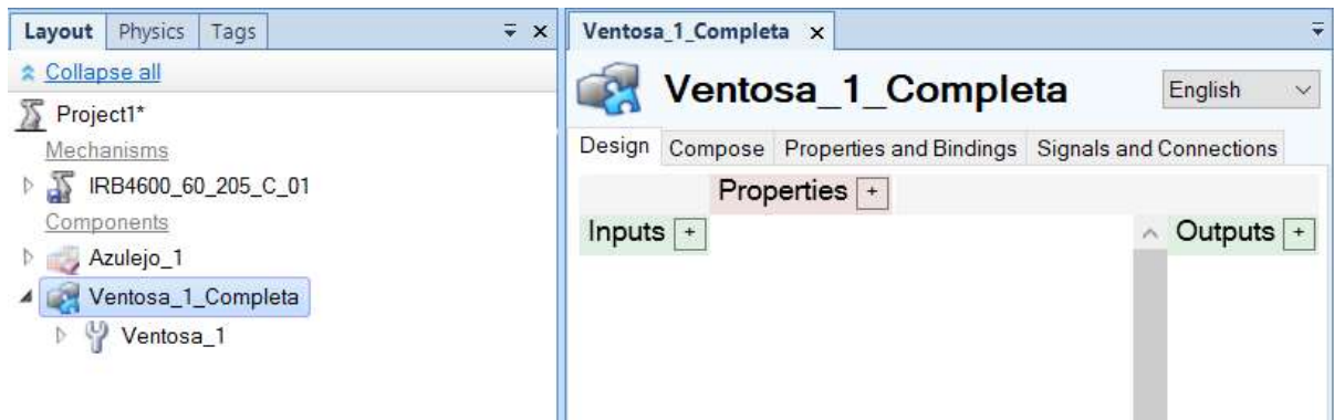
Figura 58 - Criação de um "Smart Component" para atribuir lógica de sinais à garra. Fonte: (Própria)
