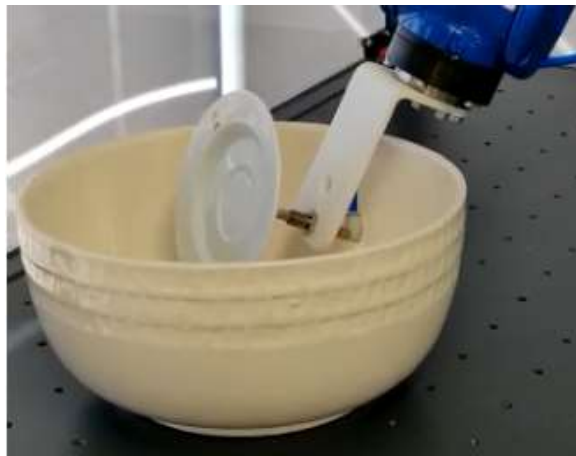
Figura 131 - Simulação de mergulho no vidrado. Fonte: (Própria)
