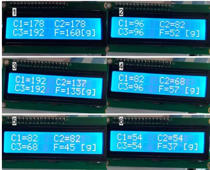
Figura 210 - Força exercida pela garra mediante variação no potenciômetro (com limite máximo). Fonte: (Própria)
