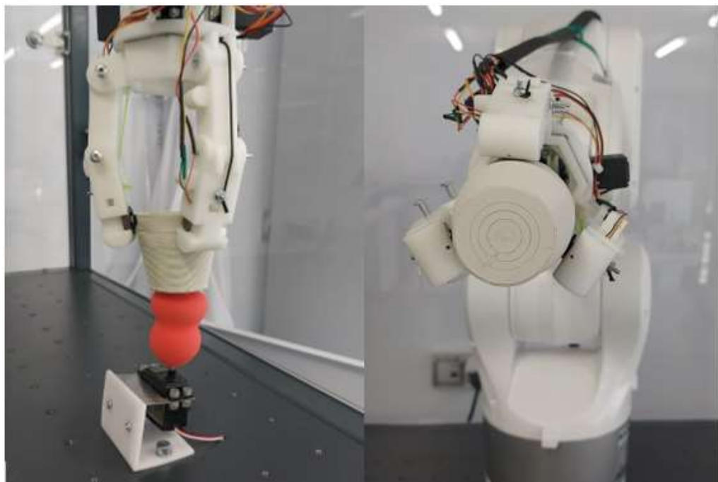
Figura 213 - Manipulação da chávena crua com garra de três dedos. Fonte: (Própria)
