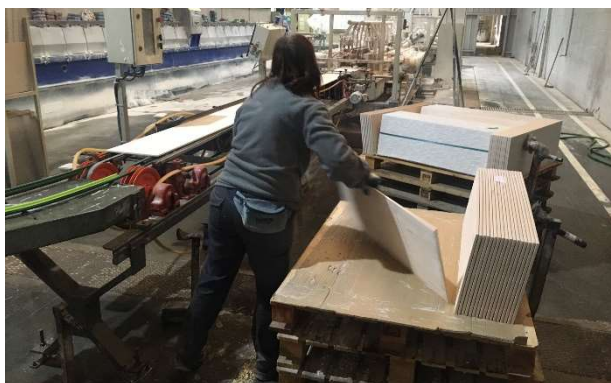
Figura 34 - Colocação de azulejos manualmente no tapete. Fonte: (Própria)
