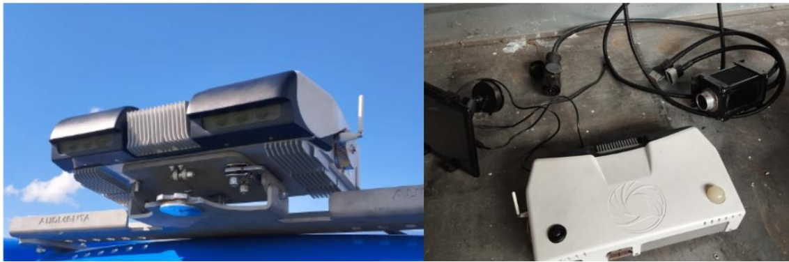
Figura 13 - Sensor Augmenta (esquerda); Sensor Augmenta e os cabos que ligam ao isobus trl4396 e monitor (direita).
