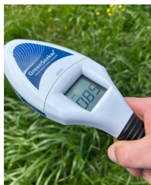
Figura 19 - Coleta dos valores de NDVI com o sensor óptico GS®.
