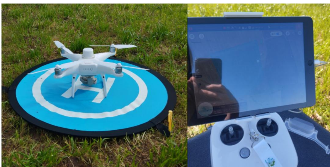
Figura 15 - Drone DJI Phantom 4 RTK Multispectral (à esquerda). Sistema utilizado para manipulação do drone em campo, tablet e controle (à direita).
