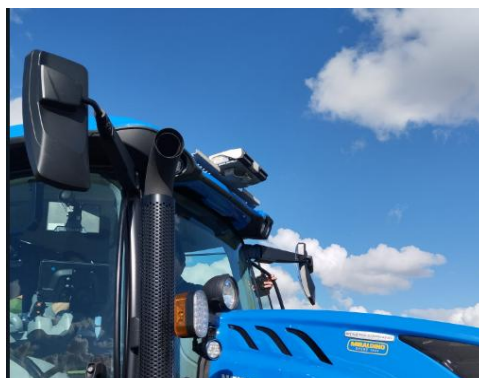
Figura 11 - Augmenta Sensor instalado na parte superior frontal da máquina.
