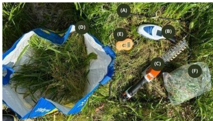
Figura 18 - (A) gabarito metálico quadrado (B) sensor GS®; (C) tesoura elétrica; (D) saco plástico; (E) balança; (F) saco plástico.
