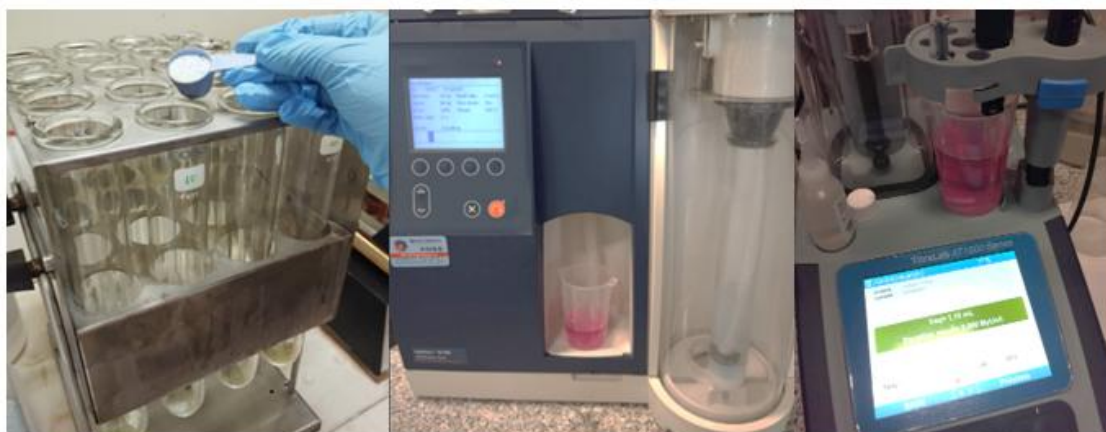
Figura 25 – Adição da mistura catalisadora; Destilação; Titulação.
