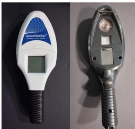
Figura 16 - Sensor óptico GS ® , modelo de sensor portátil.
