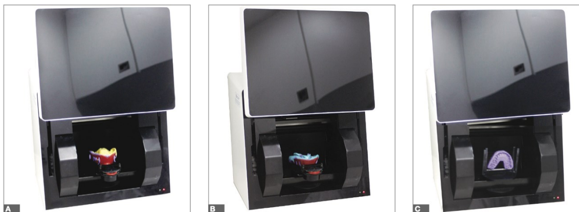
Figura 2 - Digitalização a laser da impressão com alginato (Adaptado de:Tavares Camardella & de Vasconcellos Vilella, 2015).
