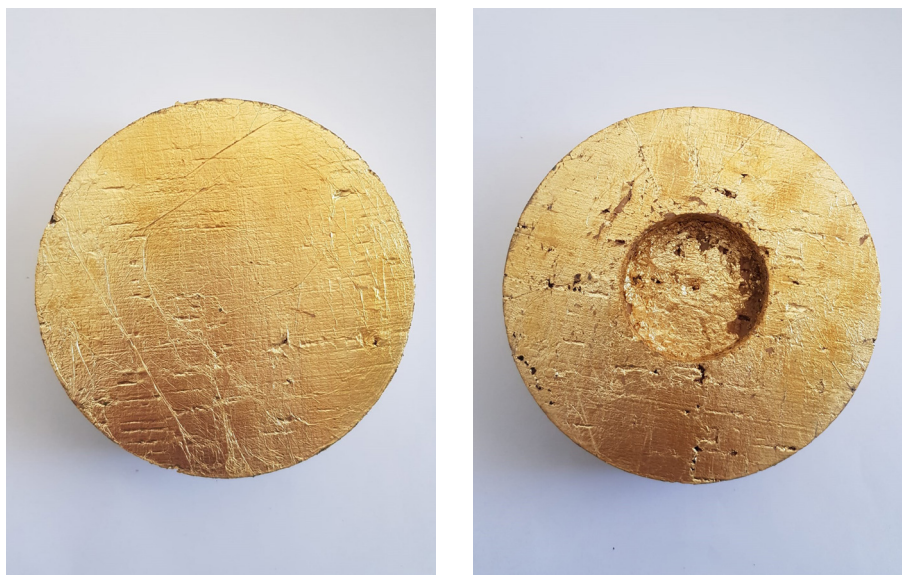
Fig.110 e 111 Aplicação da folha de ouro em cortiça natural recorrendo à utilização de goma-laca e verniz brilhante.
