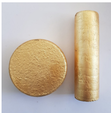
Fig.112 Aplicação da folha de ouro em aglomerado de cortiça recorrendo à utilização de goma-laca e verniz mate.
