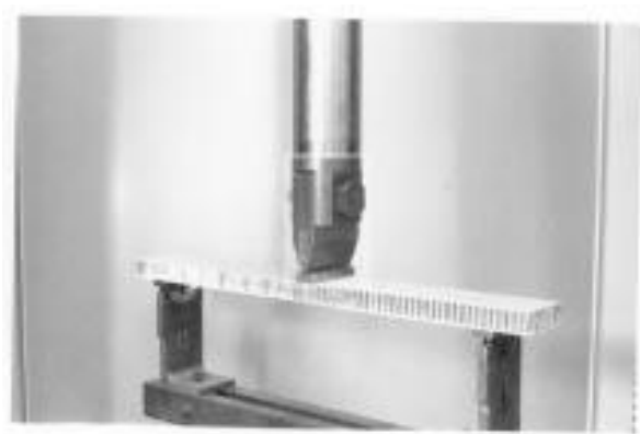
Figura 9: Ensaio de caracterização mecânica à flexão em 3 pontos.
