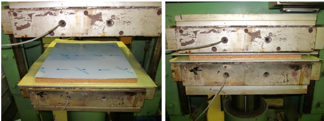
Figura 54: Colocação em prensa (esquerda) e prensagem (direita).
