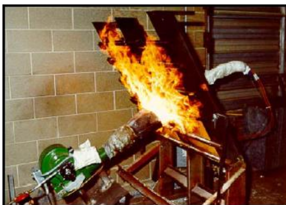
Figura 10: Teste de flamabilidade realizado num material de isolamento utilizado em aeronaves comerciais.
