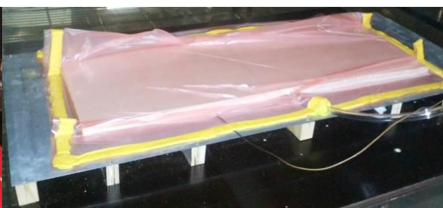
Aplicação do saco de vácuo e colocação do conjunto na câmara climática.
