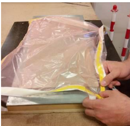
Figura 56: Bomba de vácuo e câmara climática e preparação do saco de vácuo sobre o molde das gavetas.
