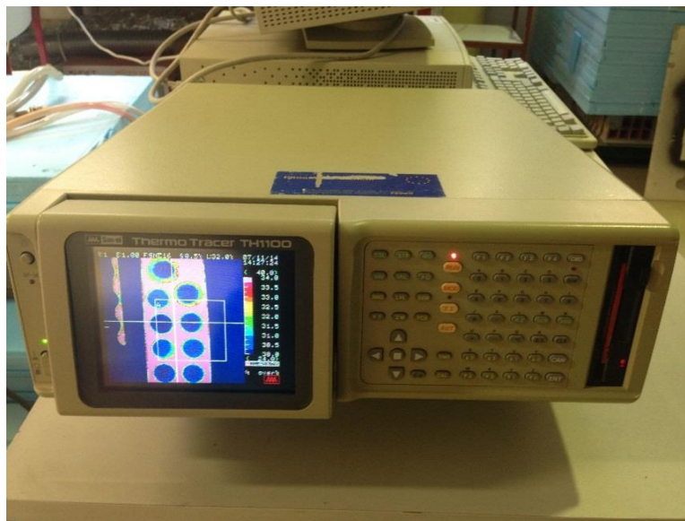
Figura 80: Sistema Termográfico Thermo Tracer TH1100.
