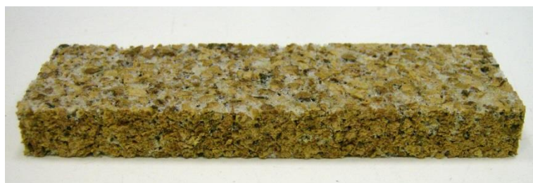
Figura 37: Corte transversal de placa de material aglomerado de cortiça com epóxi.
