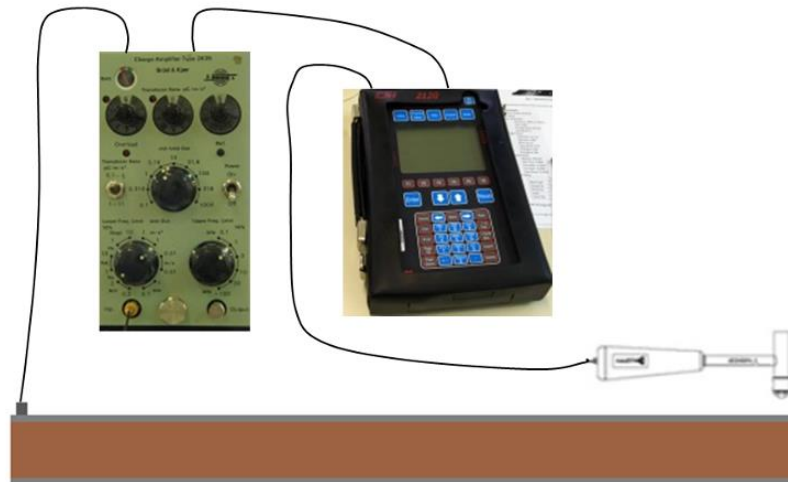
Figura 75: Esquematização do procedimento experimental.
