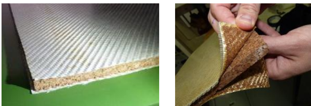
Figura 24: Fabrico de materiais sandwich na prensa de pratos quentes seguido de teste qualitativo de “peeling”.
