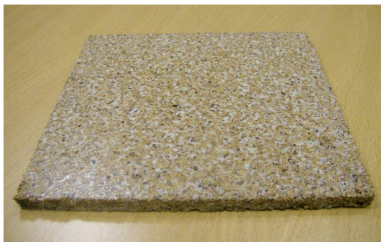
Figura 36: Placa de material aglomerado de cortiça com epóxi.
