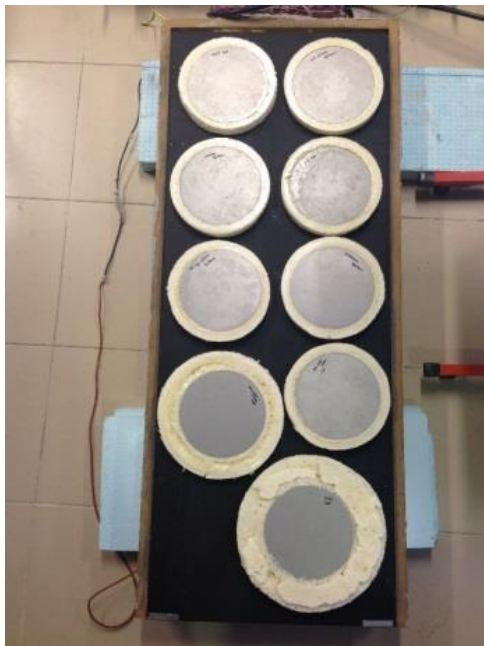
Figura 76: Placa de aquecimento com provetes.
