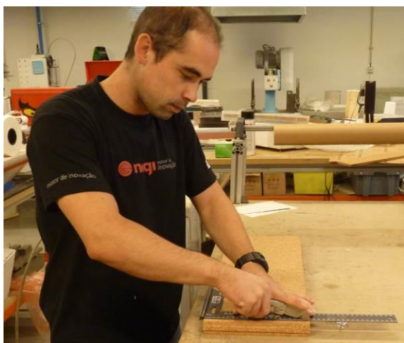
Corte dos materiais (cortiça (núcleo); adesivo termoplástico e compósitos de matriz termoplástica (peles))
