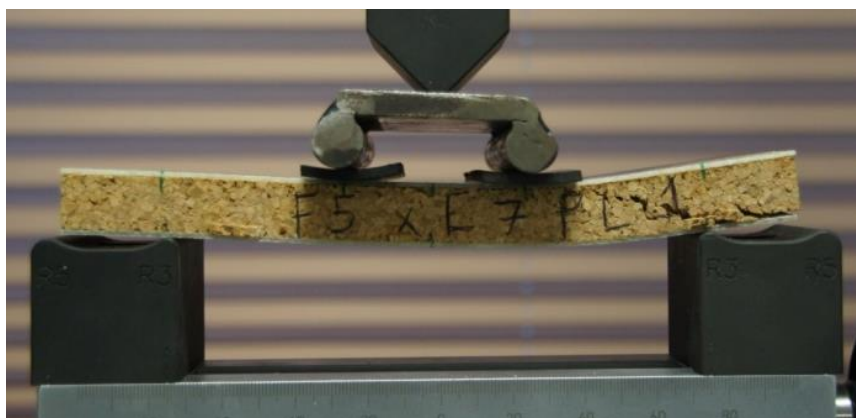
Figura 69: Falha do núcleo de aglomerado de cortiça durante ensaio de flexão.
