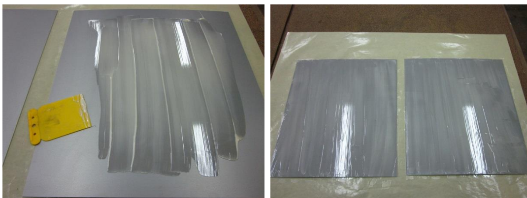
Figura 52: Aplicação manual de cola (esquerda) e aplicação concluída (direita).
