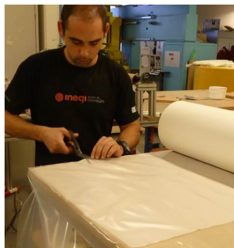
Corte dos materiais (cortiça (núcleo); adesivo termoplástico e compósitos de matriz termoplástica (peles))
