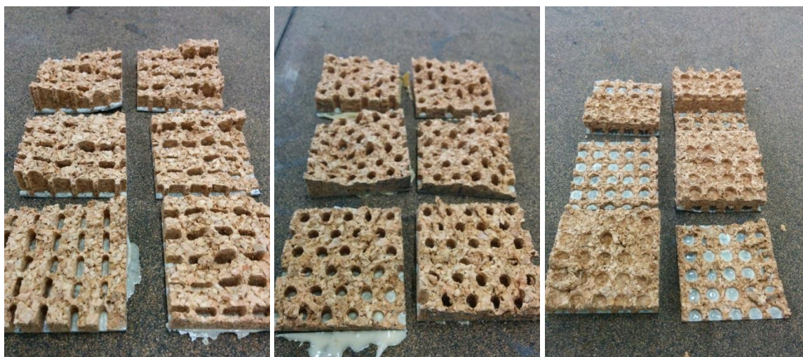
Figura 85: Ensaio adesão entre camadas DesAIR_Piso_03 (esquerda), DesAIR_Piso_04 (centro), e DesAIR_Piso_05 (direita).
