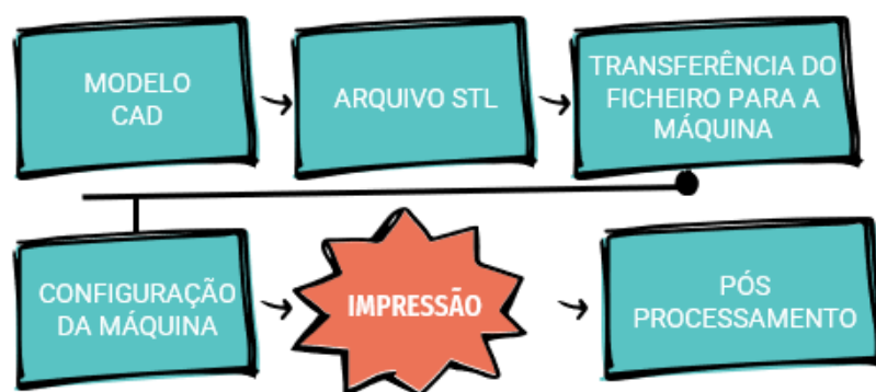
Figura 2.1: Esquema do processo de Fabrico Aditivo (Mughir, 2022)
