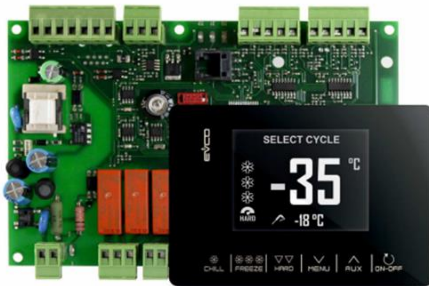
Figura 3.12 - Controlador EVJ serie 800; adaptado (EVCO, 2024).
