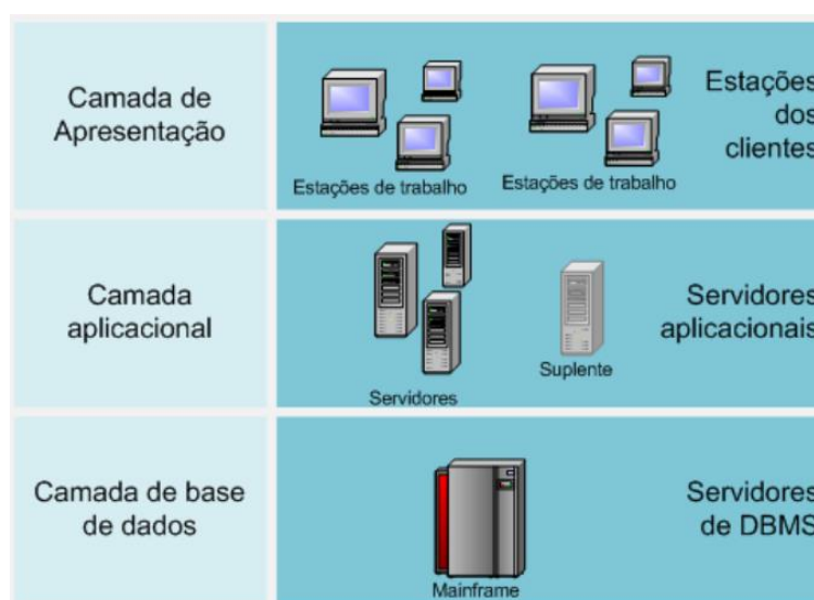
Figura 3 - Estrutura dos sistemas ERP
