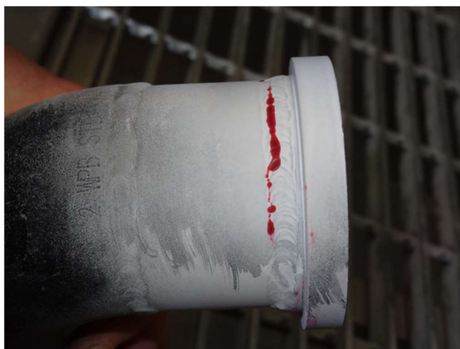
Figura 41 Exemplo de fissura revelada após ensaio de líquido penetrante (penflex.com)
