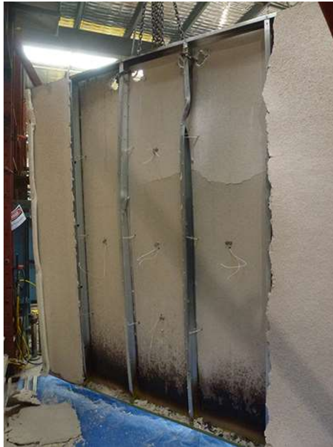
Figura 52 Distorção local e arqueamento térmico em perfis enformados a frio ( www.steel.org.au )
