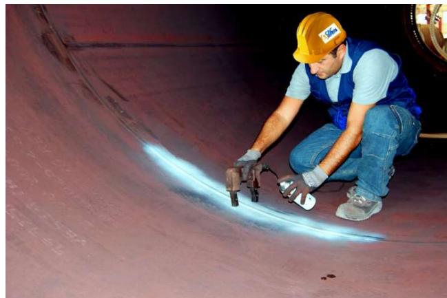
Figura 37 Ensaio de magnetoscopia ( www.cecontrol.it )
