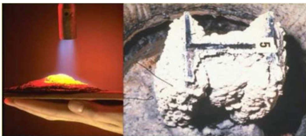
Figura 30 Aspeto da tinta intumescente durante e após incêndio (Soares, E., 2014)
