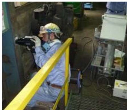
Figura 50 Utilização de um espectrômetro portátil de emissão ótica (Fujita et al., 2014)
