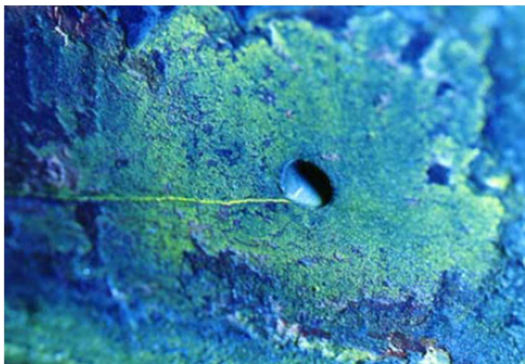
Figura 38 Detecção de fissura através do ensaio de partículas magnéticas (CEN / TC 250, 2008).
