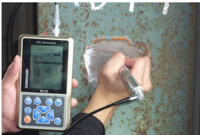
Figura 48 Ensaio para determinação da dureza (Fujita et al., 2014)
