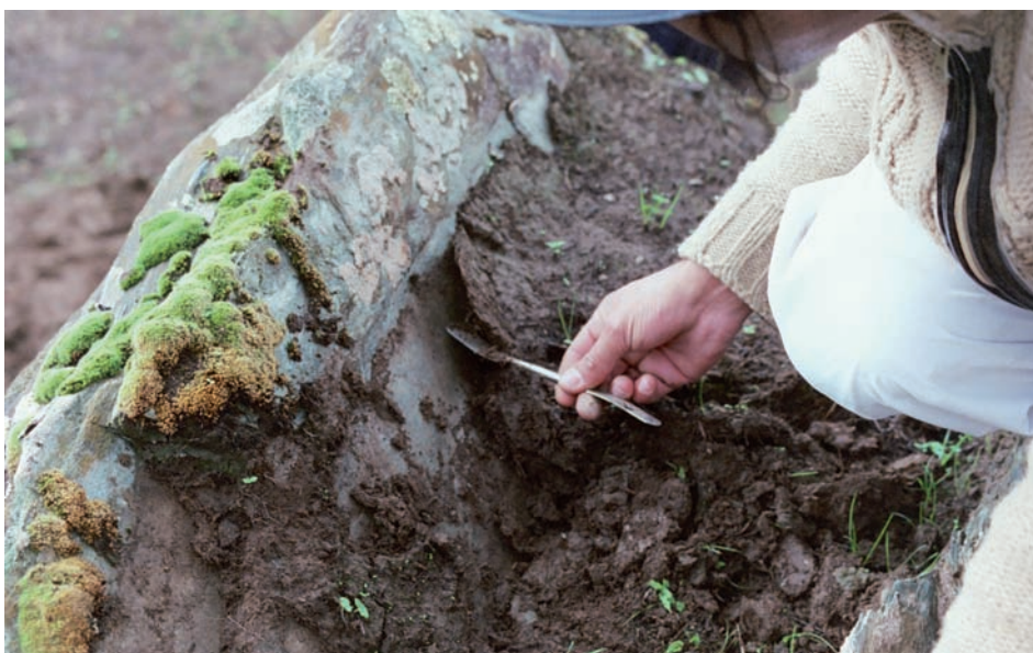
fig. 43 Aspecto da Rocha Tipo mostrando a diaclase sem parte do preenchimento terroso.
