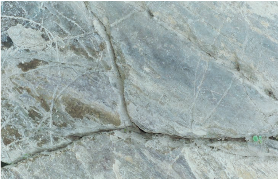
fig. 18 Pormenor de diaclases com várias direcções.
