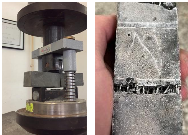
Figura 3.8 – Ensaio de caracterização da resistência à tração por flexão.
