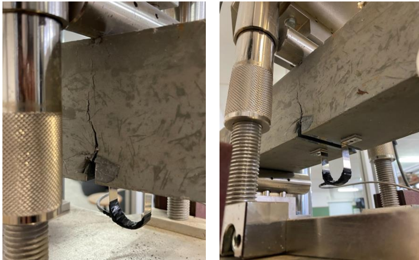
Figura 3.14 – Ensaio da resistência à tração por flexão simples – Energia de fratura e tensão residual.
