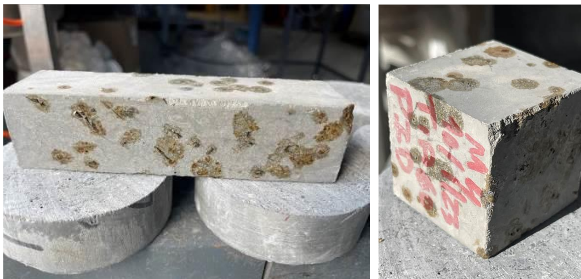
Figura 4.26 – Provete prismático e cúbico após exposição a 300°C.
