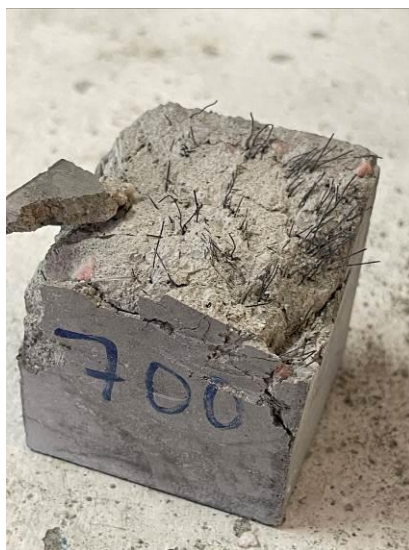
Figura 4.29 – Provete cúbico após exposição a 700°C e após realização do ensaio de resistência à compressão.
