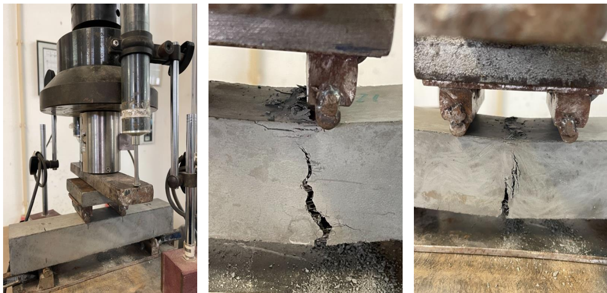
Figura 3.10 – Ensaio para determinar a resistência à flexão pura.
