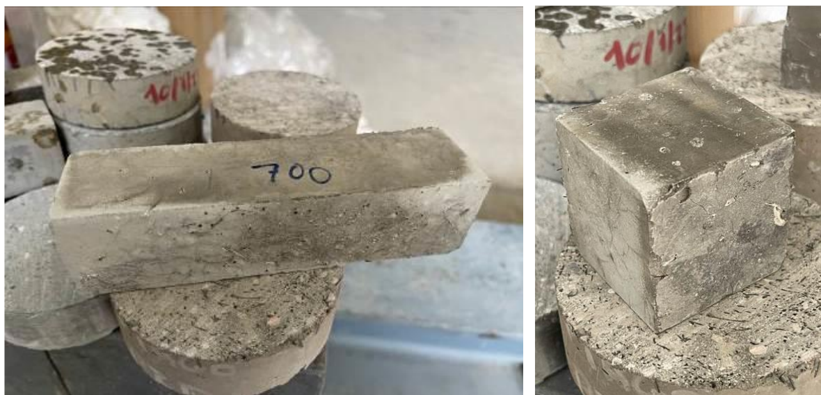
Figura 4.28 – Provete prismático e cúbico após exposição a 700°C.
