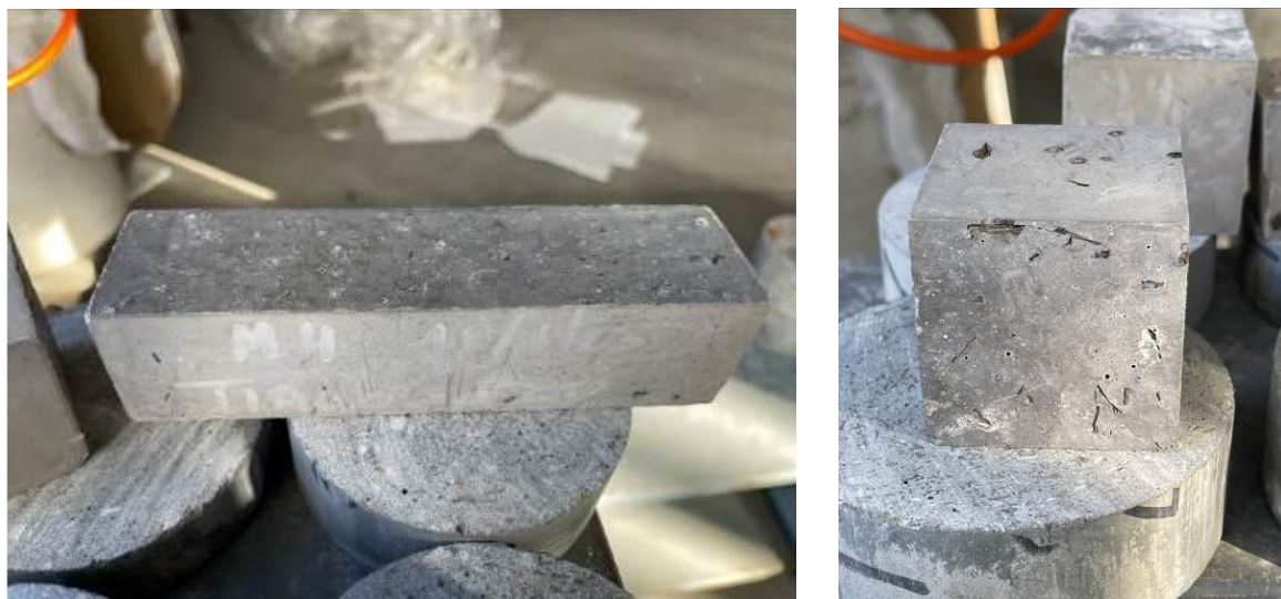
Figura 4.27 – Provete prismático e cúbico após exposição a 500°C.
