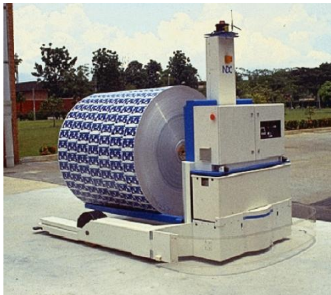
Figura 11 – Primeiro AGV a utilizar um sistema de lasers para a navegação automática [25]
