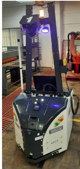
Figura 18 – Luz amarela, indicando modo autónomo
