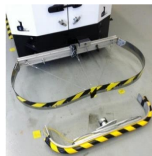
Figura 29 – AGV com para-choques adicionado posteriormente [41]
