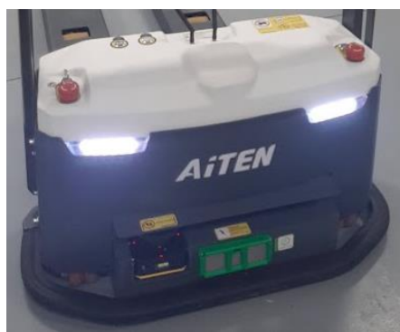
Figura 28 – AGV com para-choques de fábrica
