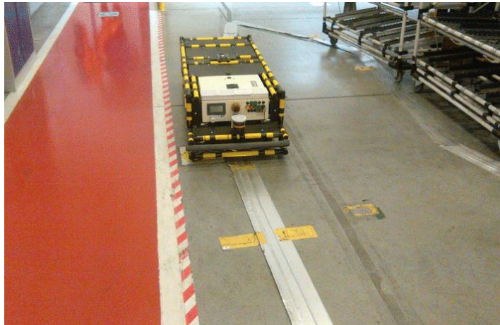
Figura 10 – AGV a utilizar uma banda magnética para a navegação automática [24]
