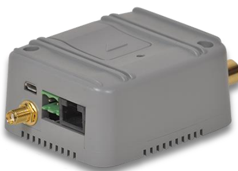
Figura 55 – Datalogger existente em cada um dos AGVs [78]
