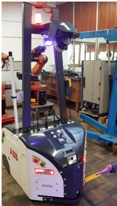
Figura 17 – Luz vermelha, indicando anomalia ou modo de emergência
