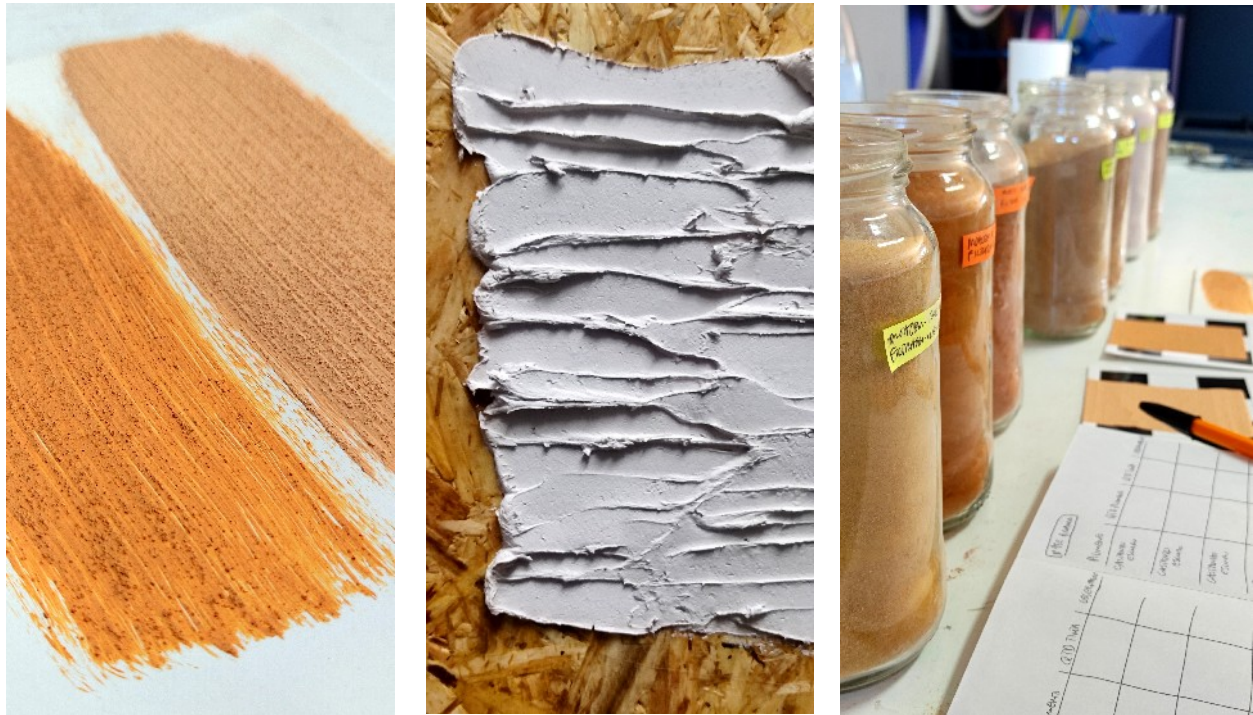
Figura 30 – Protótipo – 1C. Tintas profissionais de parede com as cores da terra – Texturas a trincha / Tinta pastosa com pigmento rosa / Registos e catalogação
