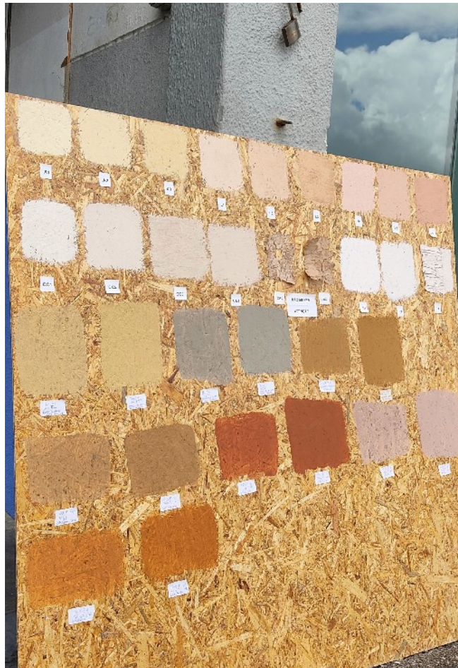
Figura 29 – Protótipo – 1C. Tintas profissionais de parede com as cores da terra – Testes em OSB
