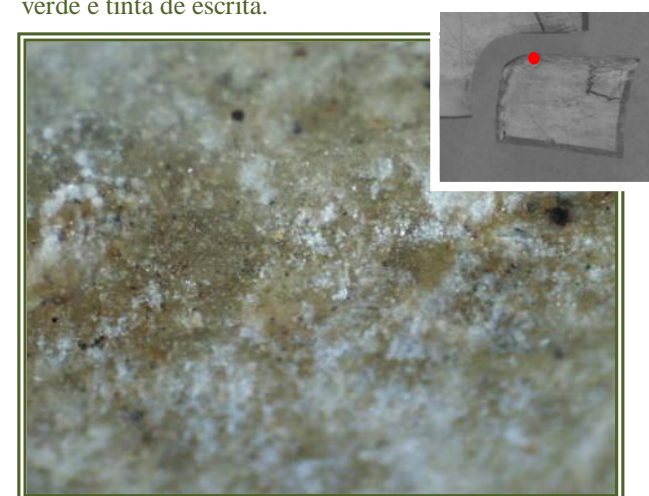
Fig. 83 – Vista de pormenor; Frente da peça – Antes das intervenções conservação e restauro; Microscopia óptica com luz reflectida (40x) – Adesivo.
